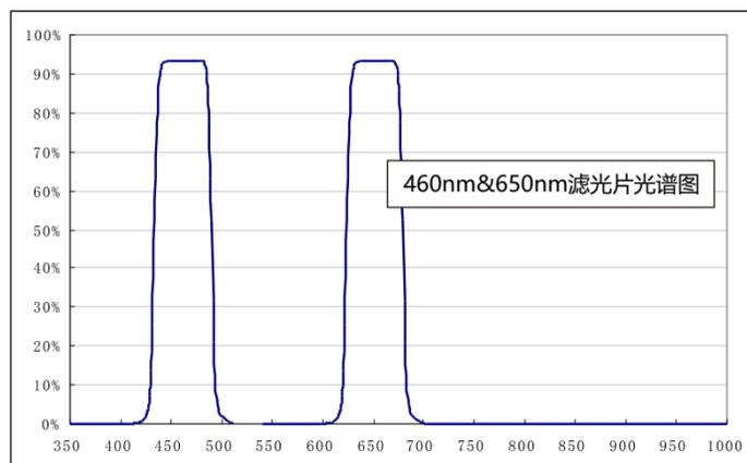
460nm&650nm滤光片光谱图
